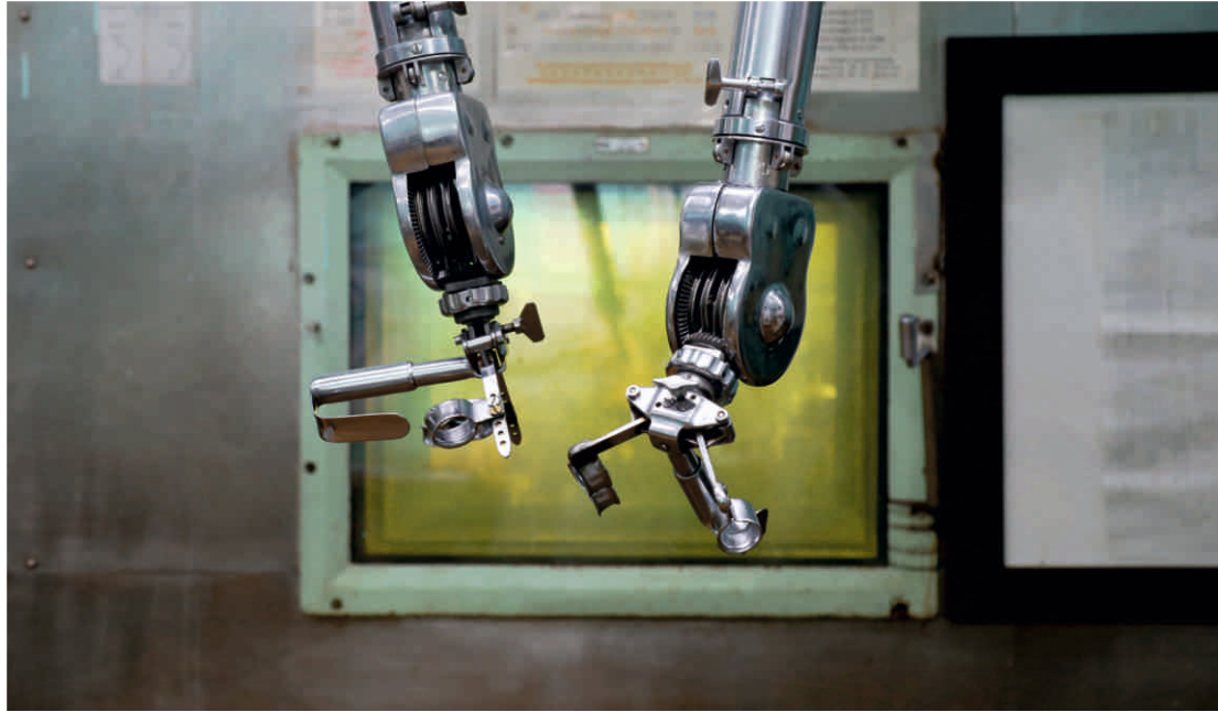
Копирующий манипулятор М-22 для работы в радиационно-защитной камере
